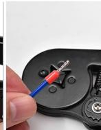
剥线长度要求: 推荐剥线长度10mm
