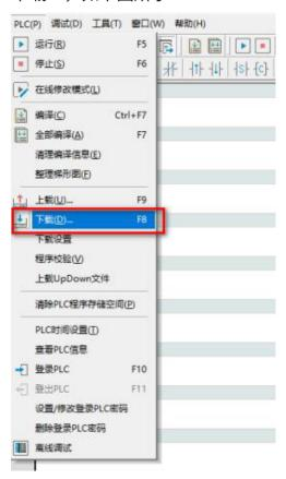
(2) 下载完成后,依次点击 "运行"图标和"监控"图标
