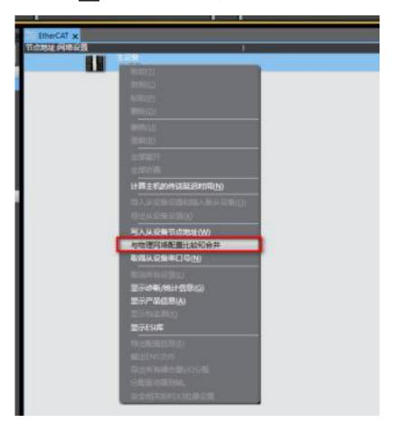
(3) 如果提示需要设置节点地址,单击"显示写入从设备节点地址对话框",写入之后,弹出重新上电提示,如下图所示,单击"写入"按钮,再根据提示重启从设备电源
