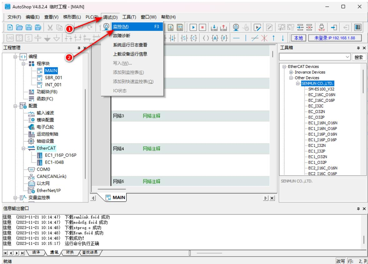
(17) 连接成功后，“工程管理”下的“EC1-I16P-O16P”“EC1-I04B”显示绿色的√，失败则会显示红色的×，如下图所示：
