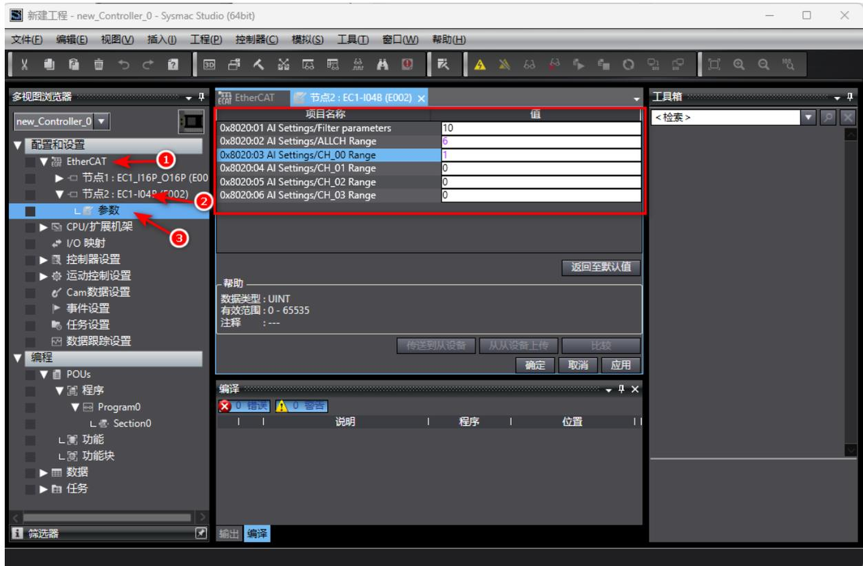
注：“EC1-O04V/EC1-O08V/EC1-O04A/EC1-O08A” OX8020:02AL Settings/ALLCH Range总通道要设置成“2”通道自定义，才能对子通道量程更改，否则以总通道设置为准；“EC1-I04B/EC1-I08B” OX8020:02AL Settings/ALLCH Range总通道要设置成“6”通道自定义，才能对子通道量程更改，否则以总通道设置为准。
