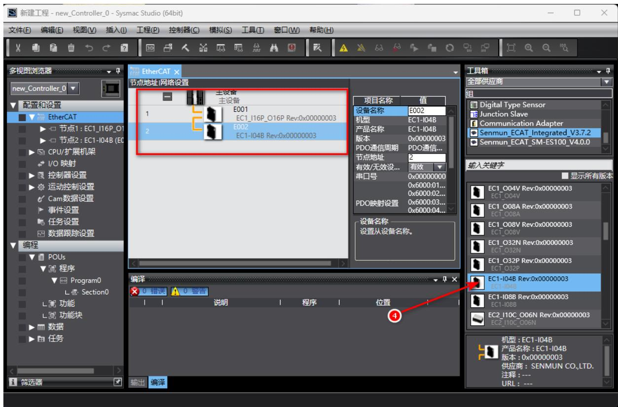
(9) 依次点击“EtherCAT” “EC1-I04B” “参数”，右键点击“编辑” 根据需要更改模拟量量程，如下图所示：
