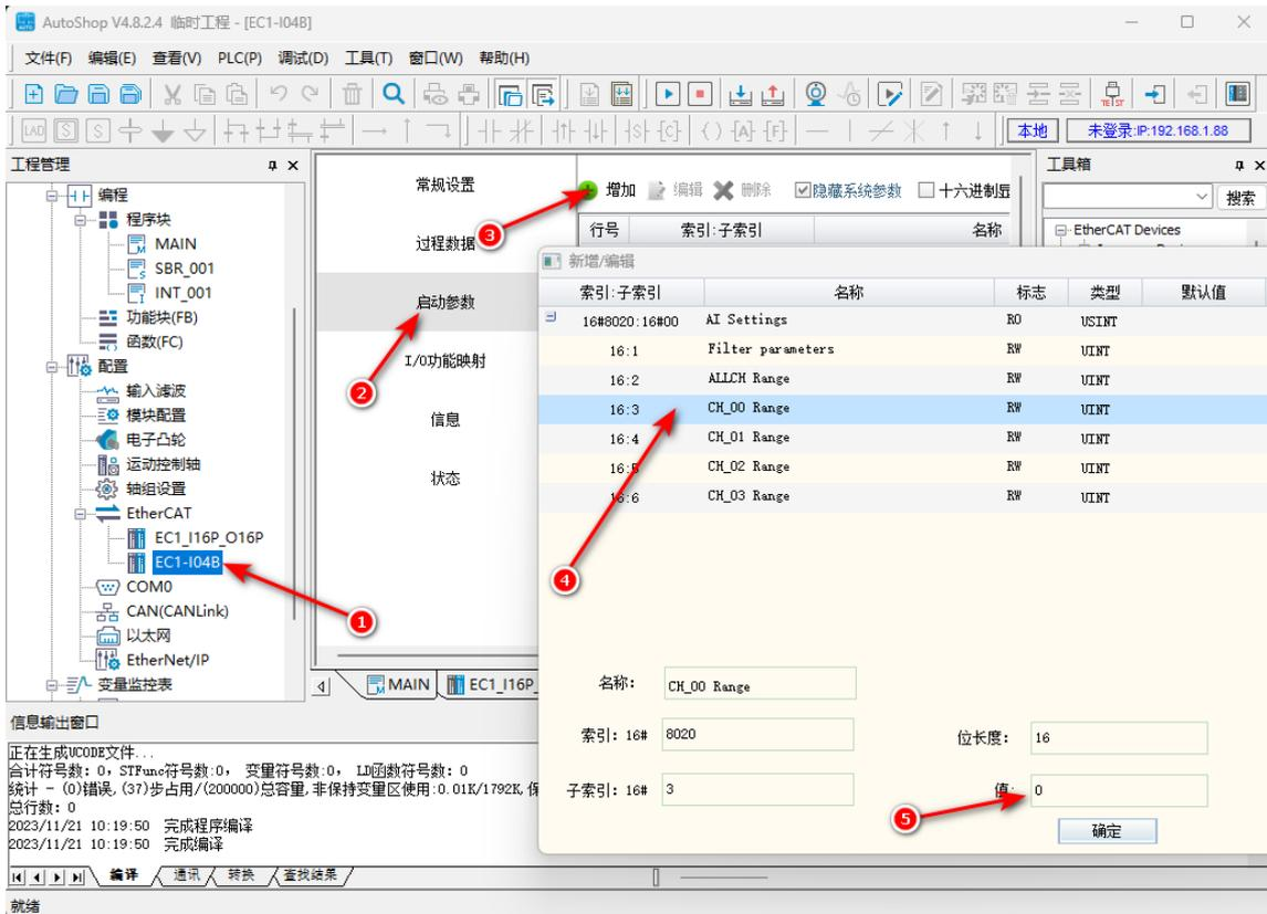
(21) 默认模拟量量程模式为0, 量程模式对应码值参数, 如下图所示:
