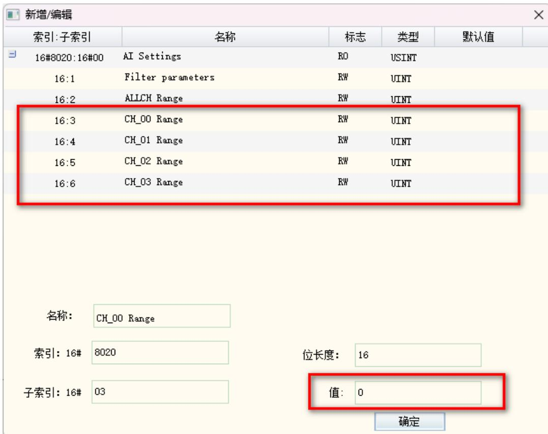
注：“EC1-004V/EC1-008V/EC1-004A/EC1-008A” ALLCH Range总通道要设置成“2”通道自定义，才能对子通道量程更改，否则以总通道设置为准；“EC1-104B/EC1-108B” ALLCH Range总通道要设置成“6”通道自定义，才能对子通道量程更改，否则以总通道设置为准。
