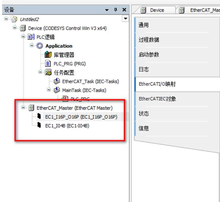
(15) 双击“EC1-I16P-O16P” 点击“EtherCAT I/O映射”将模块使能，如下图所示：
