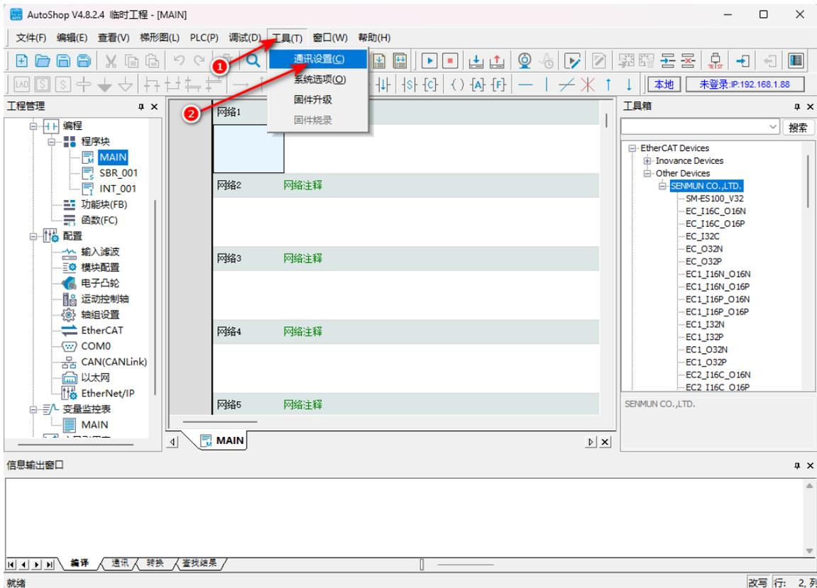
(8) 修改“PLC 通讯设置”后，点击测试，PLC 面板上“00”交替闪烁后，点击“确定”，如下图所示：
