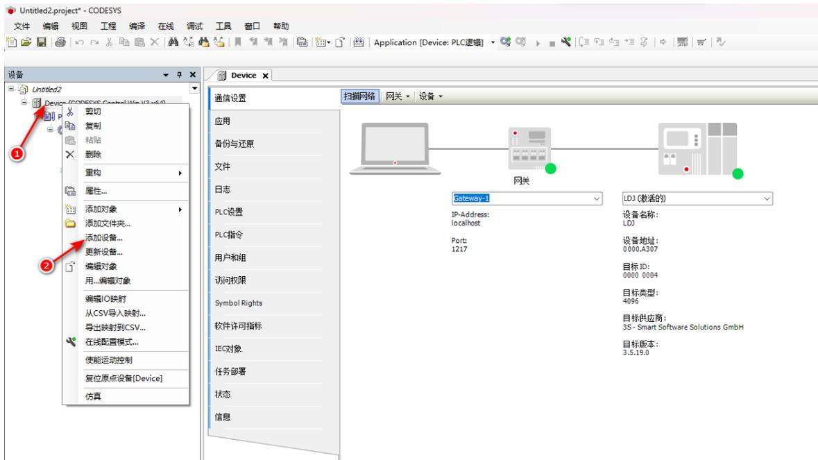
(10) 弹窗依次点击“现场总线” - “EtherCAT” - “EtherCAT Master” - “添加设备”，如下图所示：
