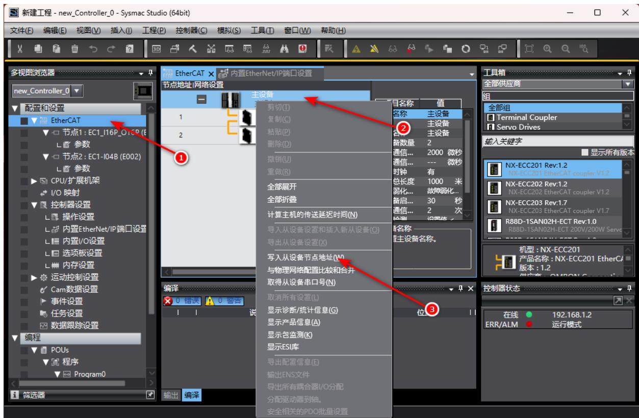
(12) 根据耦合器实际连接位置设置节点地址，设置完成后点击“写入”，点击“写入”，如下图所示：
