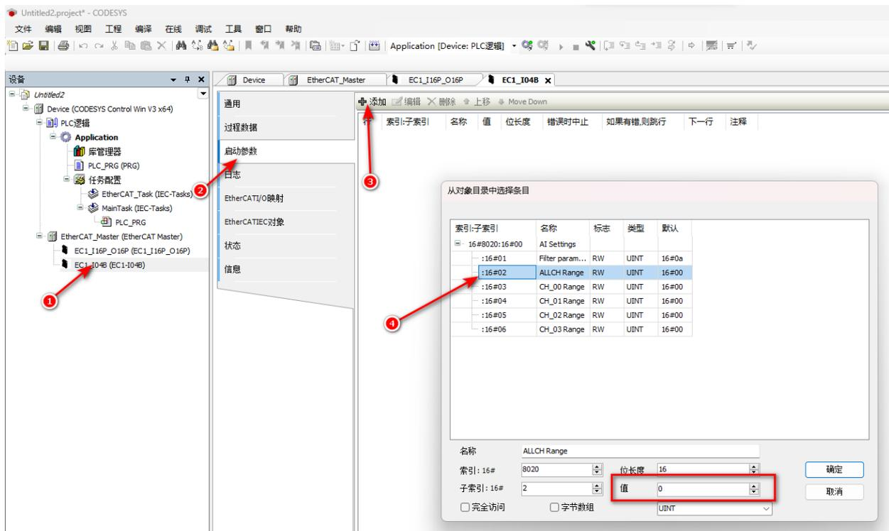
注：“EC1-004V/EC1-008V/EC1-004A/EC1-008A” ALLCH Range总通道要设置成“2”通道自定义，才能对子通道量程更改，否则以总通道设置为准；“EC1-I04B/EC1-I08B” ALLCH Range总通道要设置成“6”通道自定义，才能对子通道量程更改，否则以总通道设置为准。
