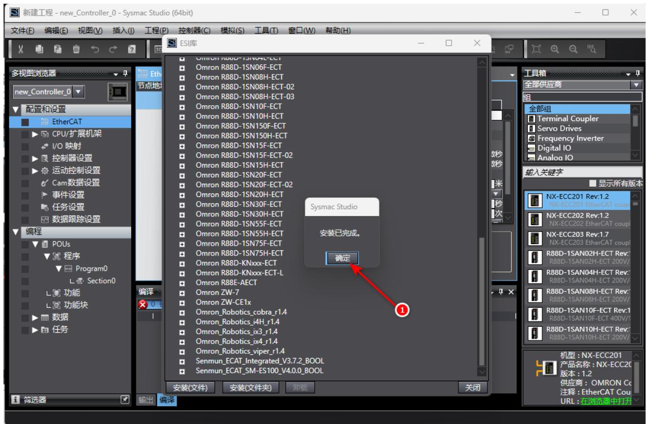
(7) XML 文件安装完成后，会在 ESI 库中出现新增的 XML 文件，确认无误后，点击“关闭”，如下图所示：
