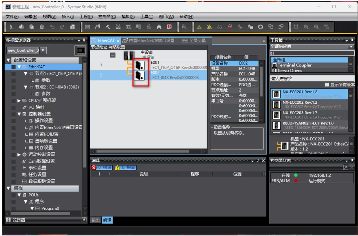
(19) 点击“I/O 映射”，右键单击需要强制输出的点，点击“设置 / 重置”即可对输出点进行强制输出；
